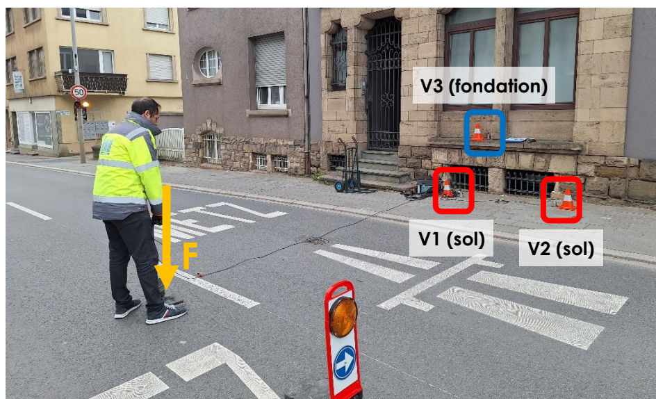
Figure 4.4 Exemple « Mesure de la transmission vibratoire »
