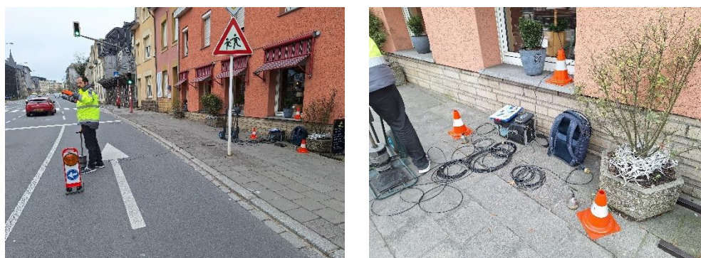
Figure 3.17 Section de mesures vibratoires S16 – 24, Route d'Esch, 1470 Lux.
